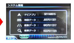
3. システム情報画面で「アップデート」をタッチし、ソフトウェア アップデート画面で「はい」を選択してください。 アップデートが開始されます。アップデートが完了するまで、しばらくお待ちください。 アップデートが完了すると自動的にシステムが再起動されます。
