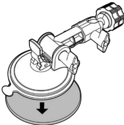
②：吸盤スタンド固定レバーを倒して固定します。
