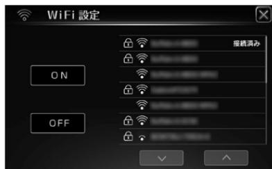
Wi-Fi を ON の状態で、電源を OFF すると、次回起動時は自動的に最後に接続したネットワークに接続します。
