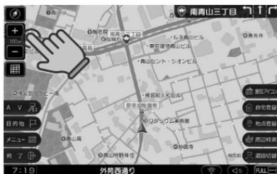
**+** / **-** を長押しすると、地図スケール変更ポップアップが表示されます。
