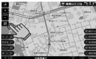
**地図角度アイコン** を長押しすると、地図角度変更ポップアップが表示されます。
